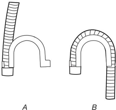
A. Emboîter l'une ou l'autre des extrémités de la bride de retenue pour tuyau de vidange sur le tuyau de vidange, au point de commencement des ondulations.
